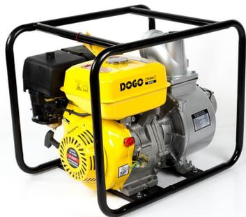
MOTOBOMBA EQUIPADA CON UN MOTOR CUATRO TIEMPOS REFRIGERADO POR AIRE DE 6.5HP. TIENE UN SENSOR DE ACEITE QUE PREVIENE ROTURAS EN CASO QUE NO SE LE AGREGUE EL MISMO. ESTE EQUIPO ES IDEAL PARA TRASLADAR LIQUIDOS CON UN PASAJE DE SOLIDOS DE HASTA 5MM DE ESPESOR Y SU CAPACIDAD ES DE 600 L/MIN GRACIAS A SU BOMBA AUTOCEBANTE COMPUESTA DE ALEACION DE ALUMINIO CON UNA ENTRADA Y SALIDA DE 2".
