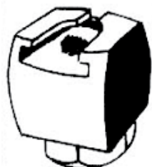
Mod. 14-A Para niples cabeza redonda Ø 22mm, rosca hembra 1/8 gas.
