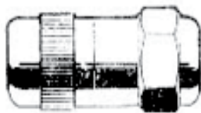
Mod. 13 Con uñas pistón y punteras de acero, cementado, superficies de contacto rectificados, rosca hembra 1/8 gas.
